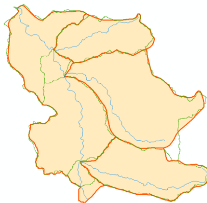
Figure 3 : illustration du sur-découpage du cours d'eau principal au niveau des confluences dans le cas des BVe (vert) par rapport au MEE (rouge)
